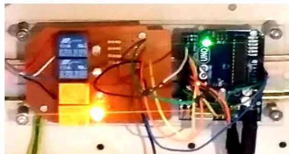
Gambar 10. Rangkaian actual Mikrokontroler Aduino Uno dan Relay
