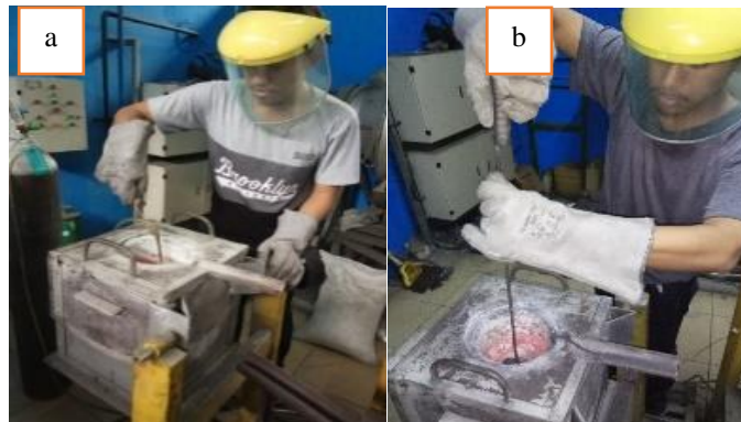
Gambar 3 : (a) Proses degassing dan (b) Proses pengangkatan kotoran/ slag .
