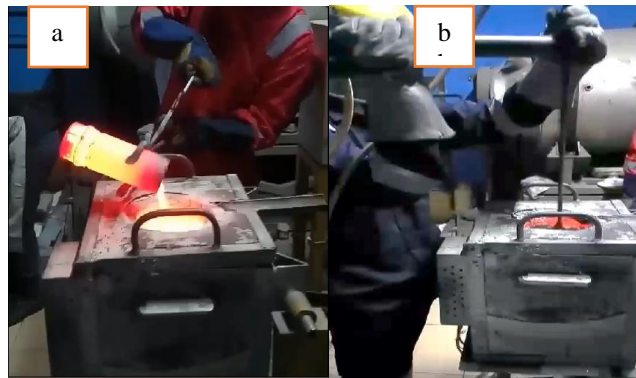
Gambar 5 : (a) Pencampuran unsur SiC dan Grafit, dan (b) Proses stirring .
