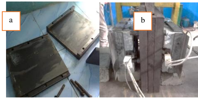
Gambar 2 : (a) Cetakan setelah proses coating dan (b) Pemasangan cetakan dengan heater .
