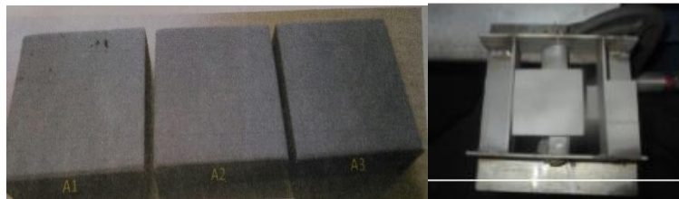
Gambar 10. (a) Pelepasan Sempel dari Jig, (b) Sempel yang telah diberi coating
