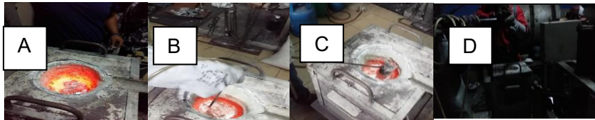
Gambar 3: (A) Proses peleburan (B) Proses degassing (C) Pembuangan kotoran (D) Proses stirring
