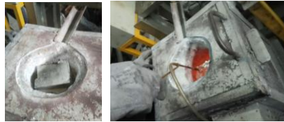
Gambar 2 Proses Peleburan Aluminium dan Proses Degassing
